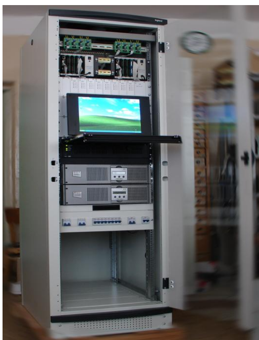
Рисунок 2 - Станционный шкаф системы КССП «Урал» с встроенным АРМом электромеханика
