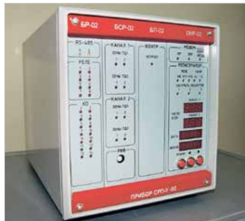
Единый контроллер управления переездом на базе прибора СРП-У
